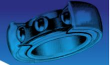
상기 도표에서 나타난 윤활 주기는 리튬 Soap Base 그리이스, 온도가 70℃ 까지 인 정상 하중 상태, 평균 베어링 하중이 (P/C<0.1)인 경우에 적용이 가능하고 높은 베어링 하중이라든지 온도가 높은 경우에는 윤활 주기가 짧아진다. 또한 베어링에 진동이 발생되면 그리이스가 기유와 증주제로 분리되기 때문에 윤활 주기 역시 짧아진다. 만약에 Seal 을 통해 오염물질이 침투되면 윤활 주기에 영향을 미치고 베어링을 통해 공기가 유동하게 되면 윤활 주기가 현저하게 짧아지게 되는데 공기 유동이 윤활제를 열화 시키고 오염물질을 베어링 속으로 유입 시키는 역할을 하기 때문이다.
