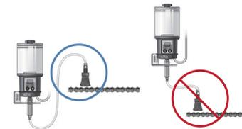
Para aceites por debajo de un ISO VG 100, asegúrese de instalar el lubricador PLC-OL480 a un nivel debajo del punto de lubricación para evitar una posible fuga de aceite. Se recomienda hacerle unos 2 o 3 lazos a la línea de lubricación durante la instalación para evitar fugas.
