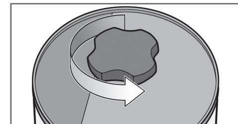
Gire la perilla en el sentido contrario a las agujas del reloj 1 o 2 veces antes de volver a tapar el depósito. Esto es para abrir el respiradero y aliviar la presión de vacío.
