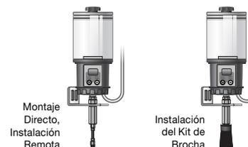
Instalación de un solo punto utilizando el kit de brocha. Favor de instalar los kits y accesorios de brocha adecuados.
