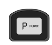
强制喷脂功能；2小时内喷出大量润滑脂，喷脂结束后需要重新设定加脂周期
