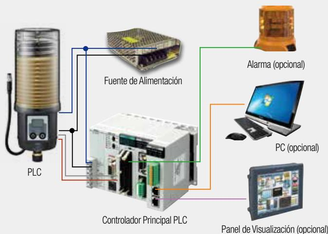
Conexión a la Fuente de Alimentación Externa (Adaptador DC solo para tipo MES)
